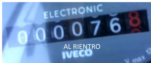
La quantità di carburante necessaria a riportare il serbatoio al pieno iniziale è stata di 19.00, evidenziando una percorrenza media specifica di 2.31 chilometri/litro.
